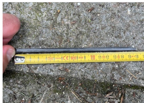
Foto 30: Spouwdiepte bepaling: 60mm
